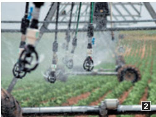
campos demostrativos se ha sustituido la carta del pivote por **emisores de baja presión** de las marcas Senninger y Komet, capaces de funcionar a una presión tan solo  $0,4 \text{ kg/cm}^2$ , frente a los  $3,5 \text{ kg/cm}^2$  que se utilizaban hasta ahora.
