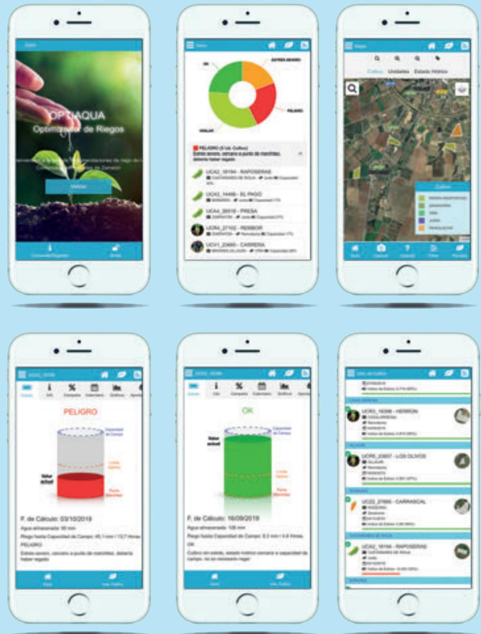
tra cada parcela mediante un código de colores; es posible analizar en detalle el estado de una parcela mediante un gráfico que emula un depósito de agua y que indica el nivel de agua existente en el suelo referenciado a los niveles máximo, óptimo y mínimo; además, se puede analizar gráficamente la evolución del agua en el suelo durante la campaña
