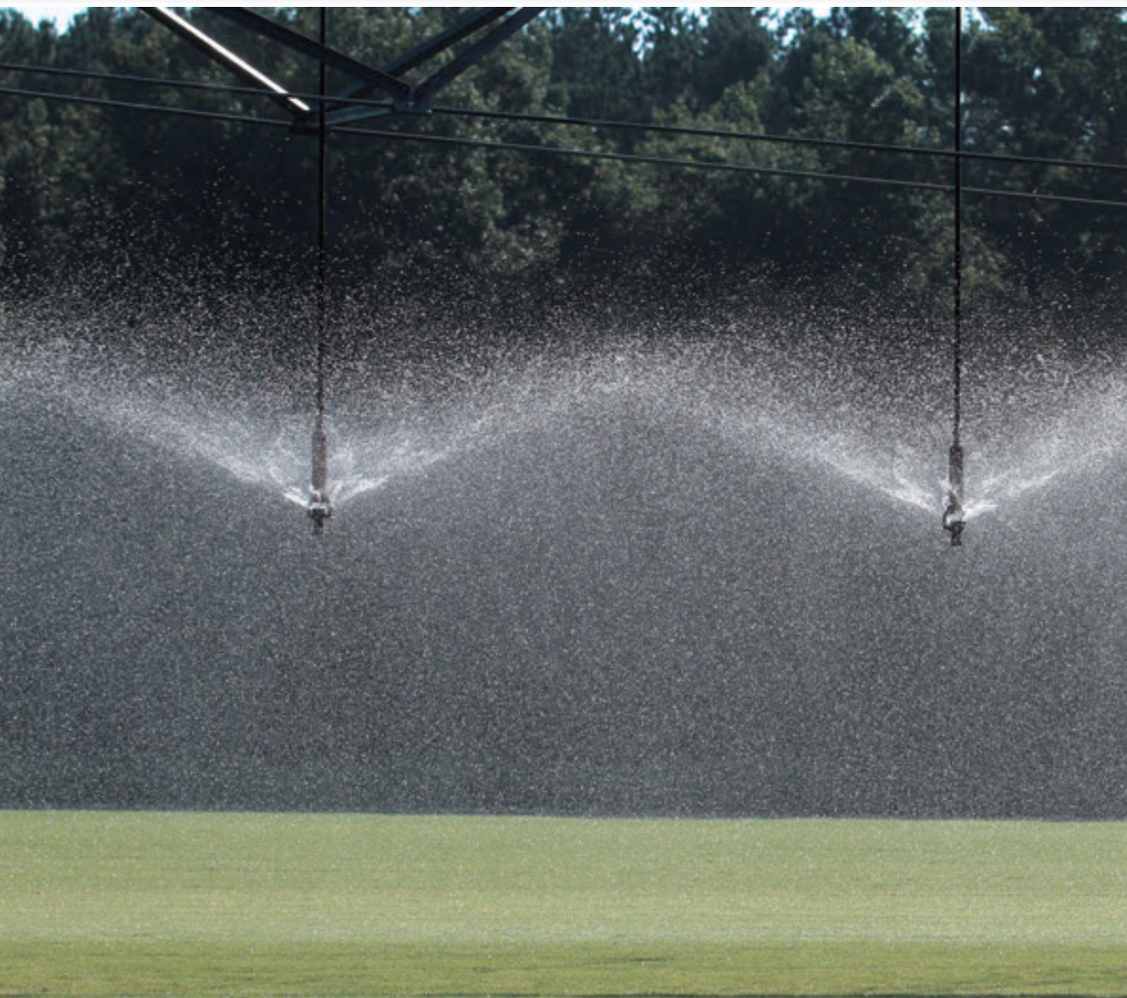
fuera una lluvia uniforme. Además se produce un goteo mínimo gracias al diseño de los soportes del cuerpo del emisor, lo que mejora la uniformidad.
