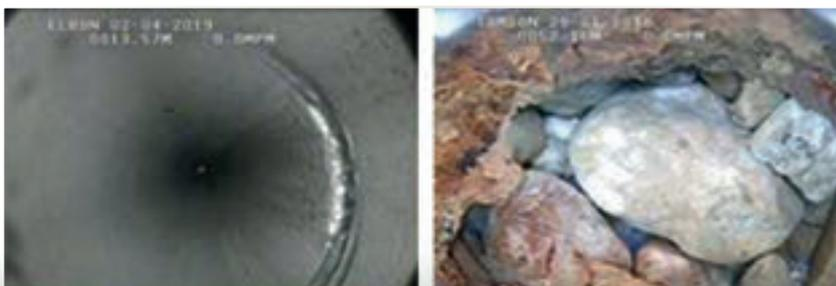
**Figura 5.** Fotografías tomadas con cámara de televisión axial y lateral mostrando la rotura que presenta la tubería de revestimiento del sondeo por el roce de las bridas de la tubería de impulsión de una bomba vertical.
