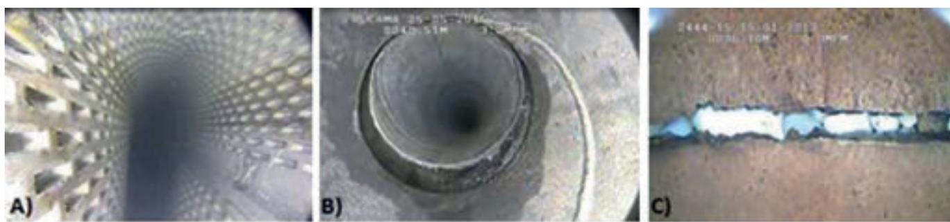
**A)** Fotografía tomada de un sondeo de reciente construcción que sufrió un aplastamiento durante la realización del aforo, probablemente como consecuencia de una mala ejecución durante el engravillado.
