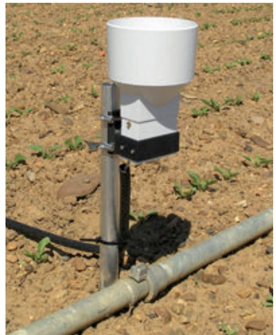
Pluviómetro en parcela para medir las lluvias.
