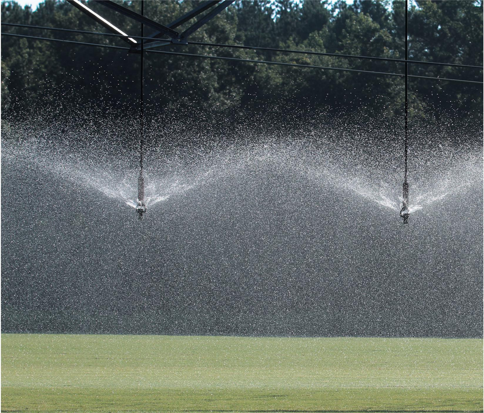
fuera una lluvia uniforme. Además se produce un goteo mínimo gracias al diseño de los soportes del cuerpo del emisor, lo que mejora la uniformidad.
